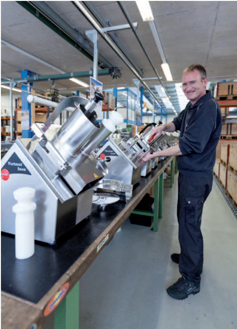
Der brandneue Gemüseschneider Rotor-Varimat Inox wird jetzt aus rostfreiem Edelstahl gefertigt und ist spülmaschinentauglich (links im Bild). Rechts das bewährte Vorgänger-Modell aus Aluminium.
